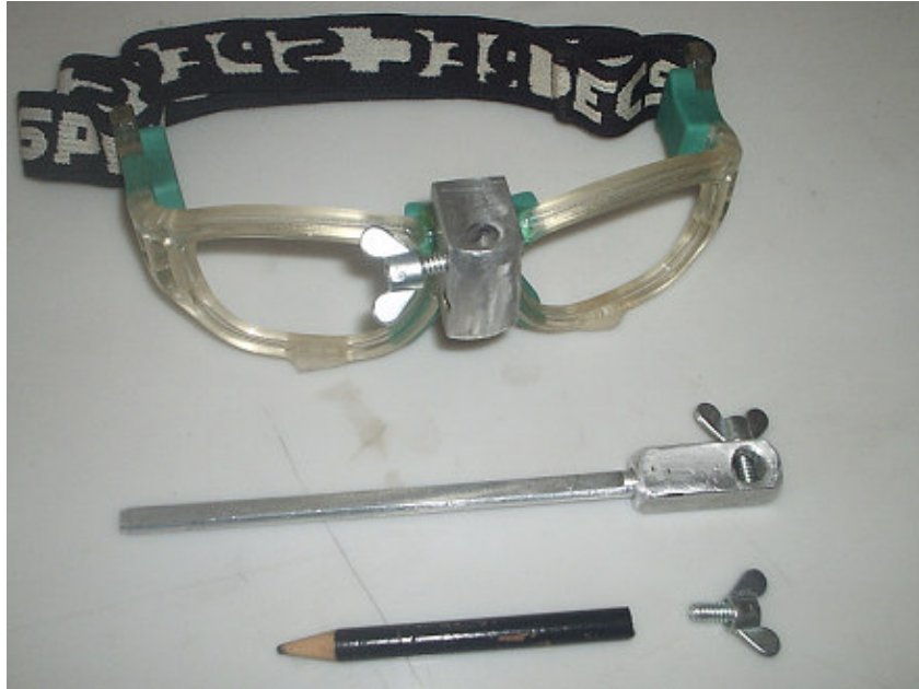
Figura 2 - Componentes do aparato: arco facial (óculos), porta base vertical de registro, lapiseira e conector de alumínio com borboletas rosqueáveis.
